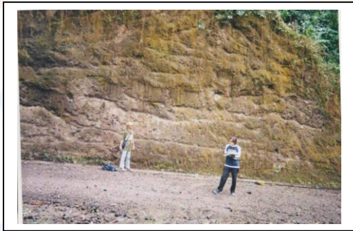
Gambar 3. Batuan Tufa yang menyusun tebing bagian atas Tukad Melangit lokasi rencana bendung Tukad Melangit
