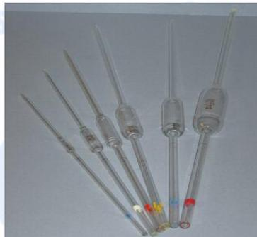
2. **Pipet ukur.** Pipet ini memiliki skala, digunakan untuk mengambil larutan dengan volume tertentu. Gunakan bulb atau karet penghisap untuk menyedot larutan, jangan dihisap dengan mulut. Pipet berukuran (graduated measuring) yang bisa mengatur jumlah volume (dengan teliti) cairan yang kita ambil, ketiga pipet tetes (medicine dropper/Pasteur pipette) yang bisa mengambil sejumlah kecil cairan.
