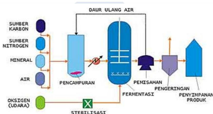
Gambar 1. Flowsheet Sederhana Pembuatan Protein Sel Tunggal
