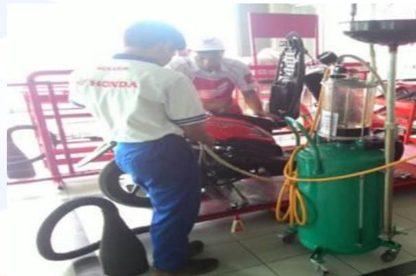
Gambar 1 Proses penggantian pelumas mesin motor (Sumber : Gani, 2016)
