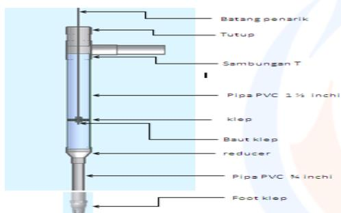
Gambar 3 pompa air torak dari bahan pipa PVC
