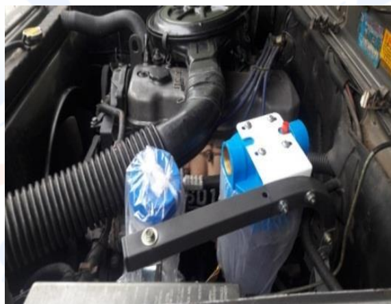
Gambar 1 Tampak Samping Posisi Dudukan Pemegang Tabung, Tabung Elektroliser dan Water Trap
