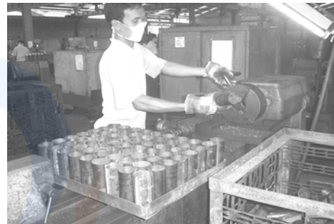
Gambar 3 Proses bevel dengan Mesin bubut
