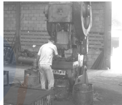
Gambar 20 Melakukan uji coba pada proses forming pipa
