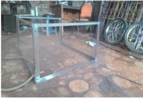
Gambar 7 Pembuatan rangka besi (Sumber : Wahyu Albin Tabrani)
