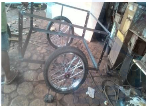
Gambar 9 Pengelasan rangka atas (Sumber : Wahyu Albin Tabrani)
