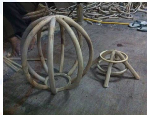
Gambar 6 Rotan yang telah dibentuk sesuai hasil 3D design
