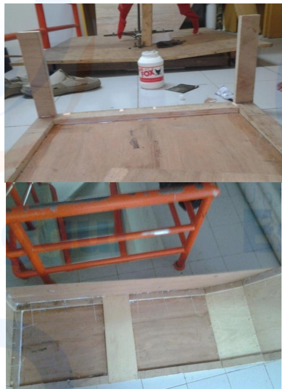
Gambar 7 Tahap 2 Pembuatan Kontruksi dan Bulkhead
