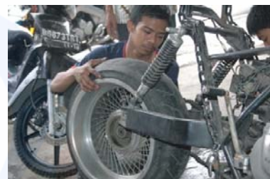
Gambar 10 Pemasangan Ban Ukuran Besar
