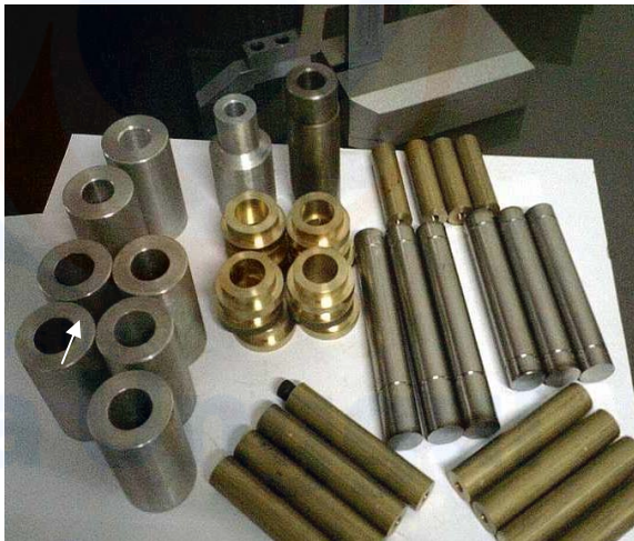
Sumber: Hasil Olahan Data Gambar 8 Stok bahan kopling (panah) sebelum proses selanjutnya
