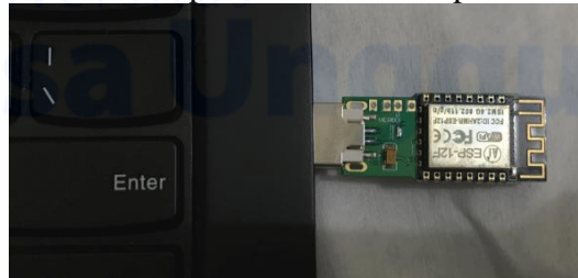
Gambar 5 Menghubungkan BadUSB ke komputer
