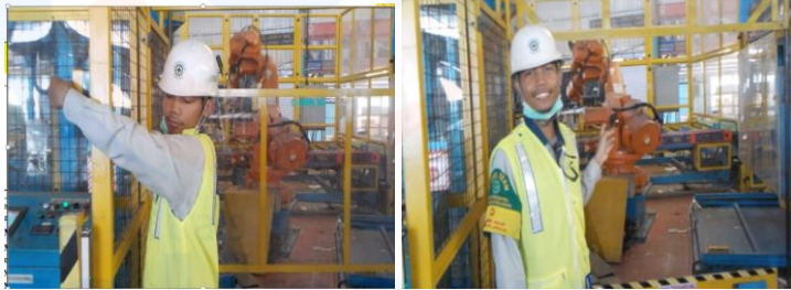
Gambar 3 Celah pada light curtain dan door curtain
