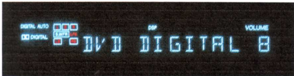
Memperlihatkan sinyal Dolby Digital yang dihubungkan dengan kabel optic pada perangkat Digital Audio Receiver (Drs. Teguh Imanto, 2007)
