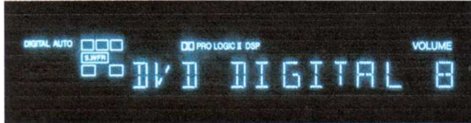
Memperlihatkan sinyal Dolby Pro Logic pada perangkat Digital audio Receiver (Drs. Teguh Imanto,2007)
