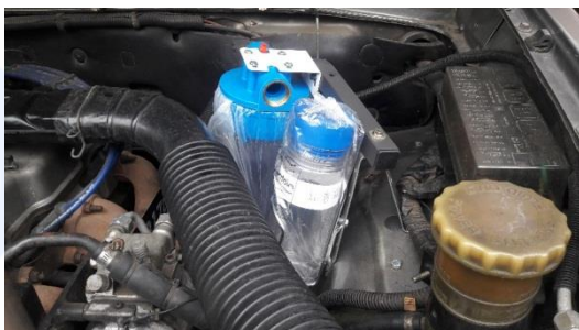
Gambar 5.1 Tampak Depan Posisi Dudukan Pemegang Tabung, Tabung Elektroliser dan Water Trap
