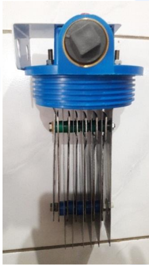
Gambar 5.10 Elemen anoda-katoda terpasang pada tutup tabung elektroliser
