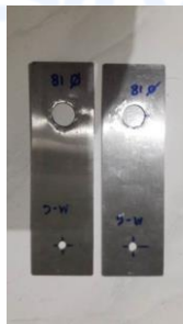
Gambar 2 dan 3 Pelat katoda dan anoda
