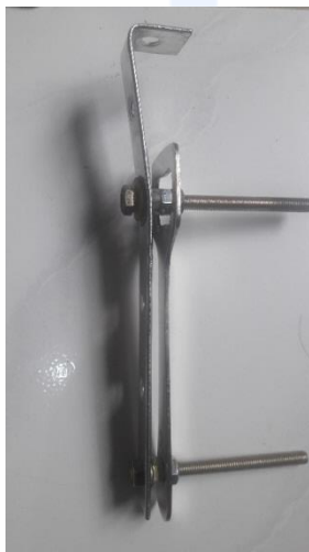
Gambar 5.6 Pemasangan elemen katoda pada baut dan pelat pemegang
