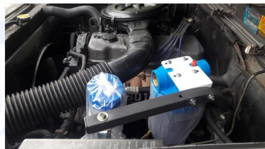
Gambar 5.2 Tampak Samping Posisi Dudukan Pemegang Tabung, Tabung Elektroliser dan Water Trap
