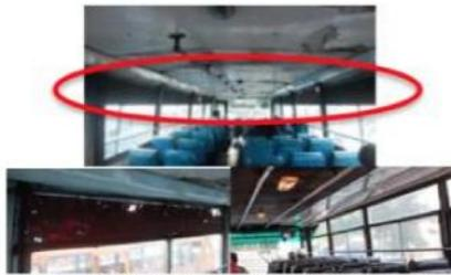
Gambar 3. Kondisi Kaca Jendela Atas Sisi Dalam Bus
