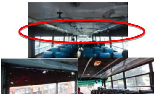
**Gambar 3.2 Kondisi Kaca Jendela Atas Sisi Dalam Bus**
