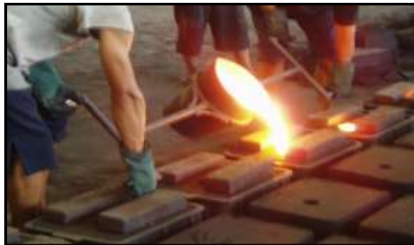
Gambar 4.14 Penuangan pada lubang cetakan
