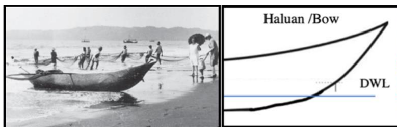
Gambar 7: Bentuk Haluan Jugong Nelayan Cilacap (Repro Situmorang 2019)
