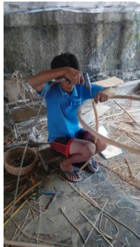
Gambar 4. 2. Proses Bending dalam Pembuatan Rangka Kursi (2) (Sumber: Pribadi, 2017)
