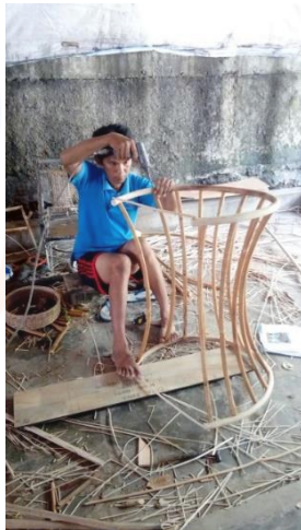
Gambar 4. 2. Proses Bending dalam Pembuatan Rangka Kursi (2) (Sumber: Pribadi, 2017)
