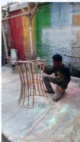
Gambar 4. 3. Proses Finishing dalam Pembuatan Rangka Kursi (Sumber: Pribadi, 2017)
