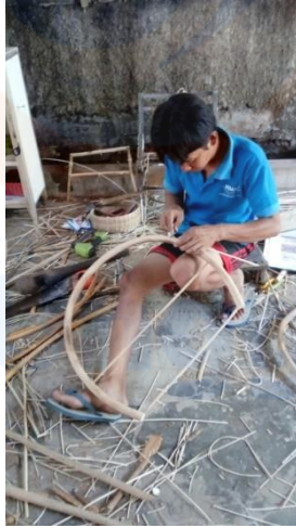
Gambar 4. 1. Proses Bending dalam Pembuatan Rangka Kursi (1) (Sumber: Pribadi, 2017)
