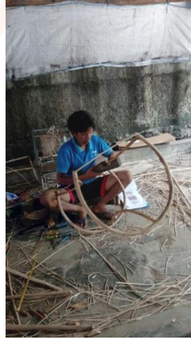
Gambar 4. 1. Proses Bending dalam Pembuatan Rangka Kursi (1) (Sumber: Pribadi, 2017)
