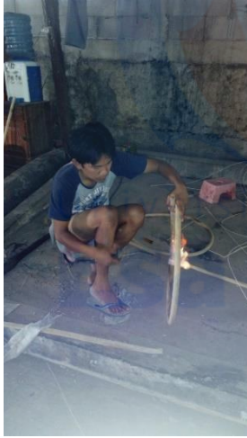
Gambar 4. 1. Proses Bending dalam Pembuatan Rangka Kursi (1) (Sumber: Pribadi, 2017)
