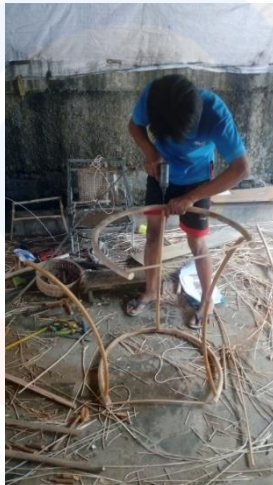
Gambar 4. 2. Proses Bending dalam Pembuatan Rangka Kursi (2) (Sumber: Pribadi, 2017)
