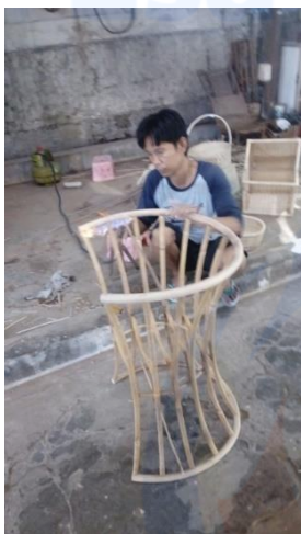
Gambar 4. 3. Proses Finishing dalam Pembuatan Rangka Kursi (Sumber: Pribadi, 2017)
