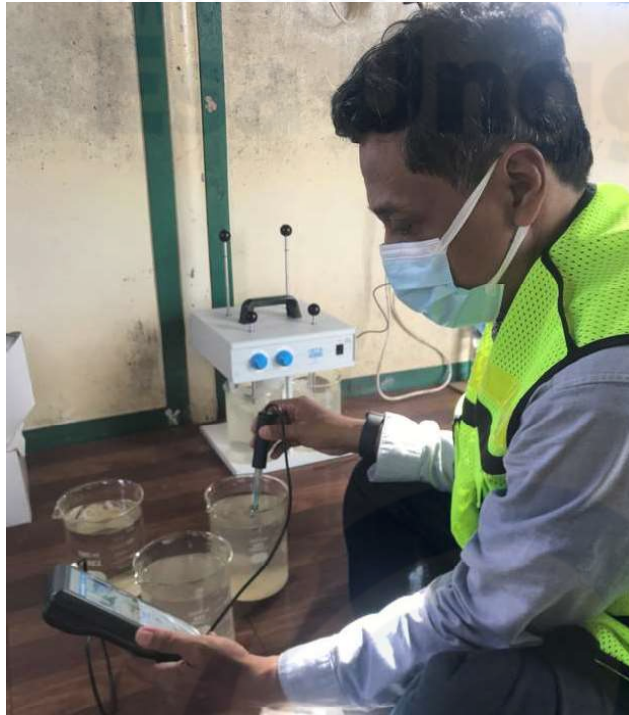
Dokumentasi pengujian Jarrest pada saat pembacaan pH dengan alat pH meter setelah proses jarrest sudah dilakukan
