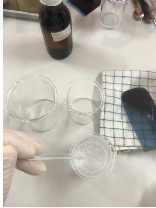
Metil paraben dan propil paraben dilarutkan ke dalam gliserin
