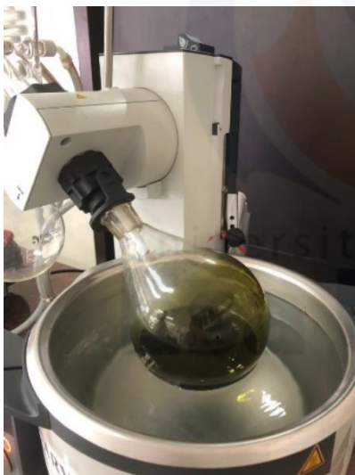
Filtrat dipekatkan menggunakan rotary evaporator
