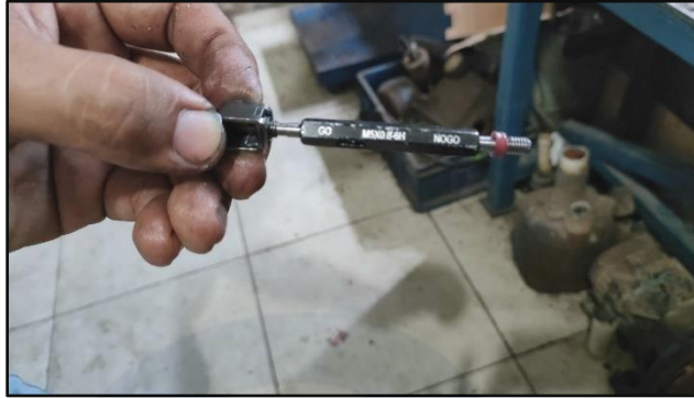
Gambar 1. 7 Alat Thread Plug Gauge M5X0.8-6H (GO + NOGO) (Sumber : Pengamatan di PT. Anugerah Sinbet Mandiri)
