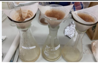
Proses pemisahan kalsium sulfat dengan asam laktat
