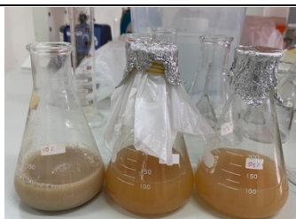
Hasil fermentasi dengan penambahan \text{Ca}(\text{OH})_2 hingga menghasilkan kalsium laktat
