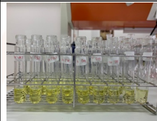
Pengujian kadar asam laktat pada sampel yang sudah direaksikan dengan \text{FeCl}_3 menghasilkan warna hijau-kekuningan
