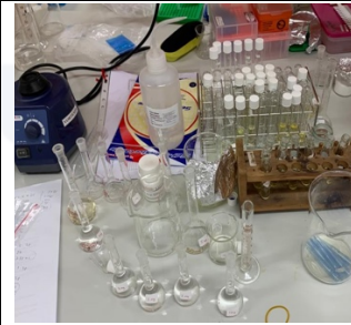
Proses pengenceran sampel untuk pengujian kadar asam laktat
