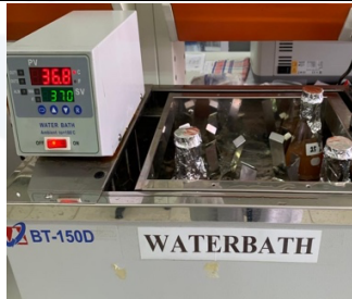
Proses fermentasi menggunakan waterbath shaker dengan suhu 37°C dan kecepatan 150 rpm
