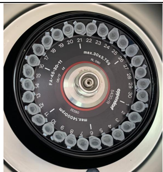
Hasil penyamplingan di sentrifugasi dengan kecepatan 7000rpm
