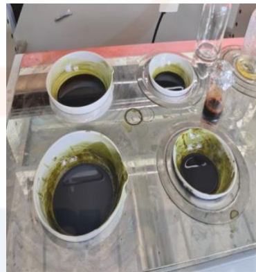
Proses pengentalan di waterbath
