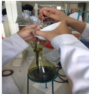
Ekstrak dimasukkan kedalam rotary botle
