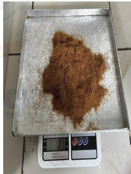
Didapatkan serbuk halus serabut buah lontar tua dengan pengayakan 40 mesh.
