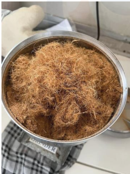
Hasil serabut buah lontar tua setelah di grinder.
