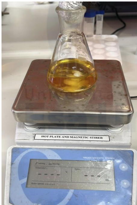
Lampiran 3 Homogenasi LB broth dengan Ampicilin menggunakan Magnetic Stirrer
