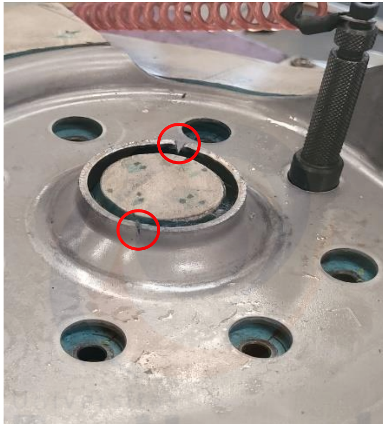
Lampiran 2 Crack pada Seat Spring
