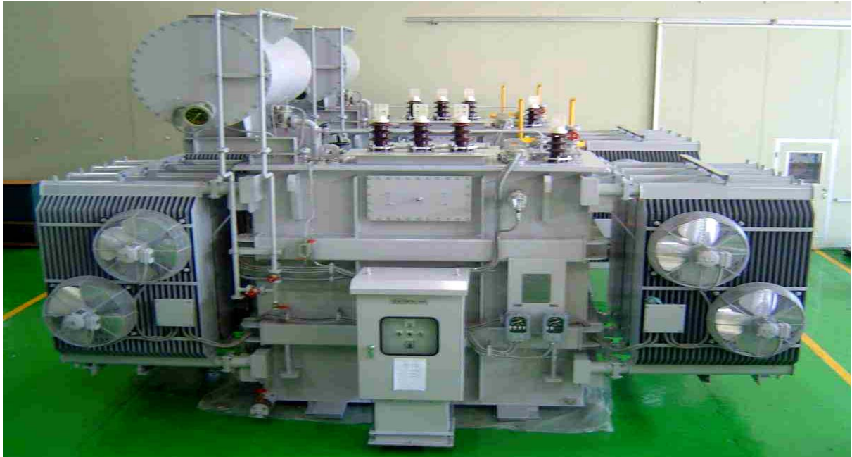
Instalasi Pendingin Dengan Blower
