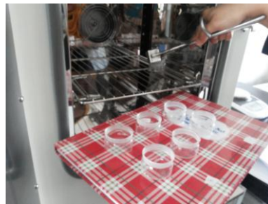
Memasukkan cawan kosong ke dalam oven selama 2 jam
