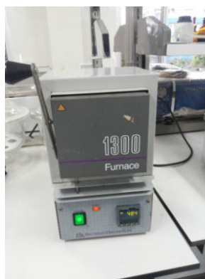
Cawan+sampel dimasukan ke dalam tanur selama 2 jm
