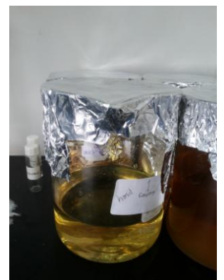
Setelah 2 hari di ambil cairannya dan sampel diganti dengan cairan etanol baru
