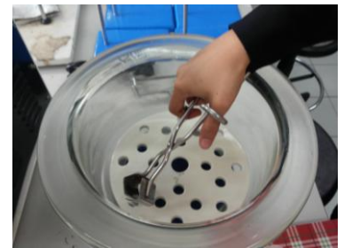
Masukkan cawan kosong ke desikator untuk didinginkan selama 30 mnt
