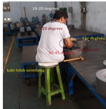
Gambar 5 Sudut Pergerakan Metode RULA untuk Elemen Kegiatan Menyusun Silicon Steel
