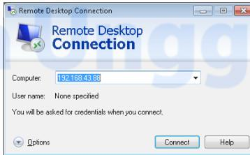
Mula-mula, melakukan koneksi antara Raspberry Pi dengan PC menggunakan jaringan *tethering* atau *hotspot smartphone*. Raspberry Pi menggunakan IP Address 192.168.43.88 dan PC menggunakan IP Address 192.168.43.167. Kemudian menggunakan aplikasi *Remote Desktop Connection* (untuk pengguna OS Windows) agar dapat menjalankan Raspberry Pi.
