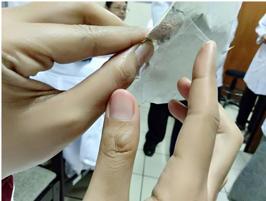
Gambar 7. Nanoserat yang diperoleh dari aluminium foil
